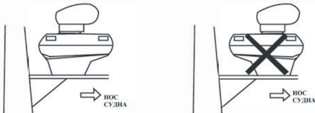
Рисунок 3. Ориентация антенного блока радарной антенны МИРАН «АМ-12»
